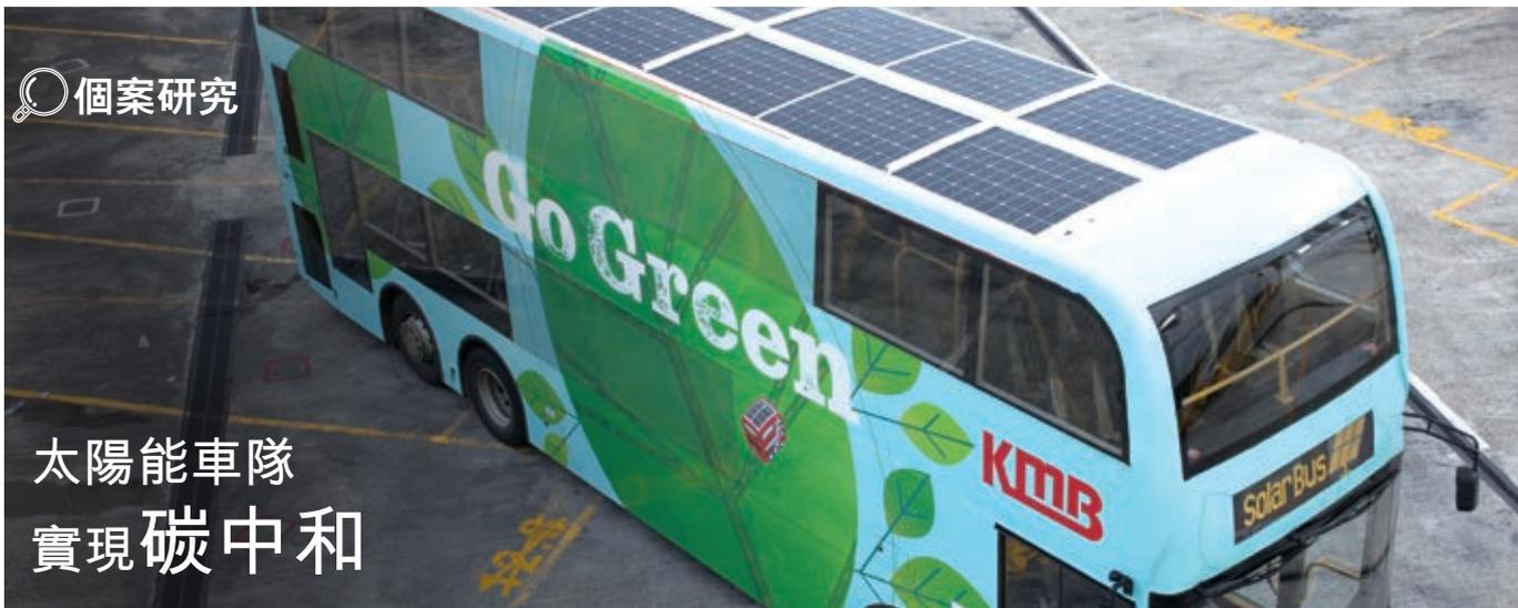
為緩解全球暖化危機，九巴積極推動可再生能源應用。安裝在巴士車頂的第三代太陽能裝置，所收集的電能會供予車廂冷氣系統的16把風扇。巴士停車熄匙後，當車廂溫度達至35度時，由太陽能供電加裝的抽風機便會啟動，將車內的熱空氣抽出，車廂溫度最多可降低約攝氏8至10度。因此能為每部巴士每日節省約7公升燃油，耗油量減少5-8%，相等於每年減少約6噸碳排放。九巴在2017年已經開始研發巴士太陽能裝置，與上一代相比，第三代裝置可產電面積增加，太陽能薄膜只有兩毫米厚，能直接貼在巴士車頂上，毋
