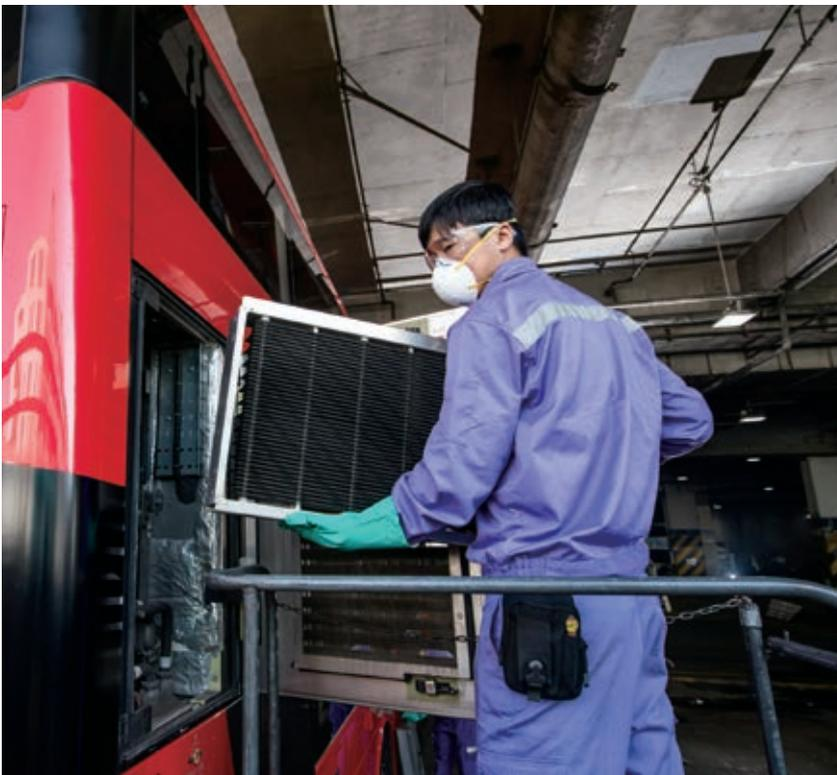
○ 新一代環保冷氣系統備有電子隔塵網，有助改善車廂內空氣質素
